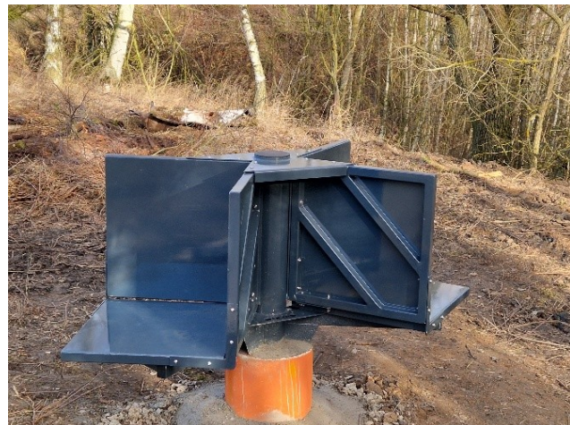
Konečné provedení prototypu koutového odražeče – dvojlavice, v terénu (před konečnou terénní úpravou)
