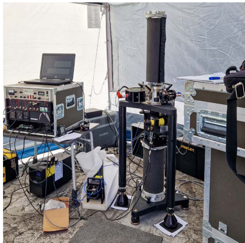
Absolutní gravimetr FG5X-251/HS5 a rozložená měřicí aparatura VÚGTK při měření ve stanu
