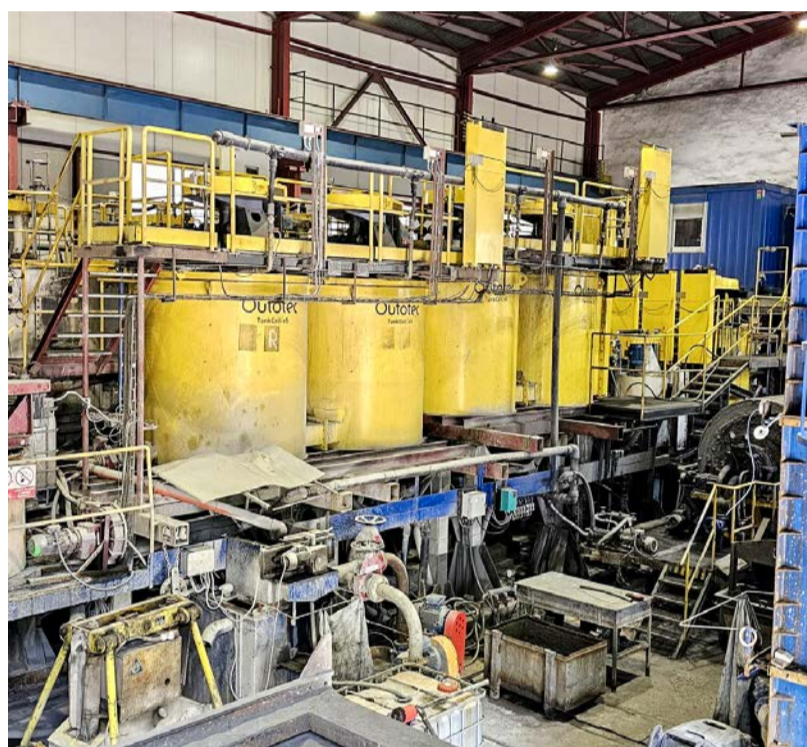
Sekce úpravny, kde probíhá flotace ve flotačních celách
