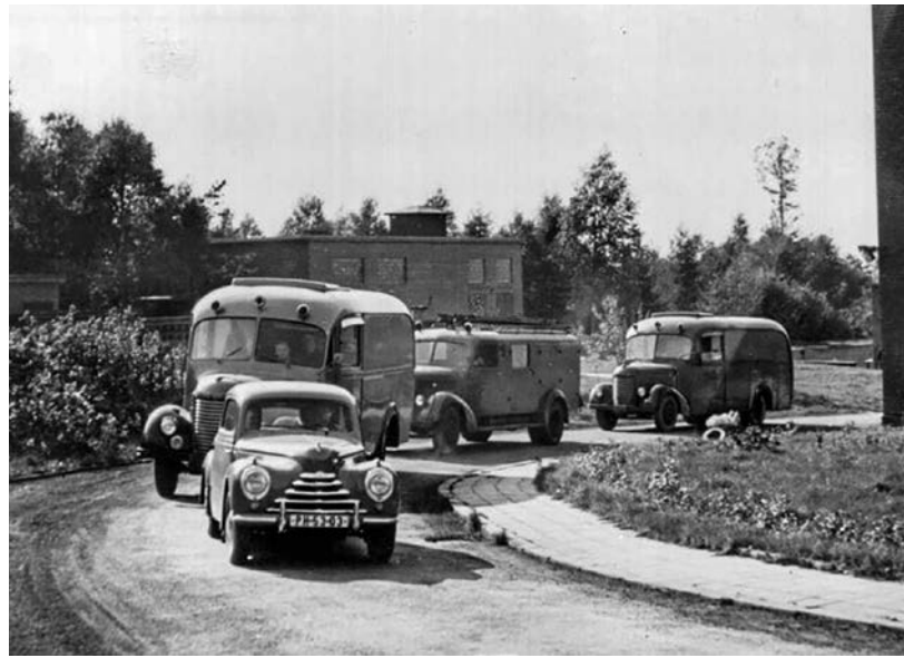
Vpředu Škoda 1102 Tudor, dva výjezdové autobusy Praga RND, uprostřed automobilová stříkačka Praga RN AS-16 (1600 l/min)
