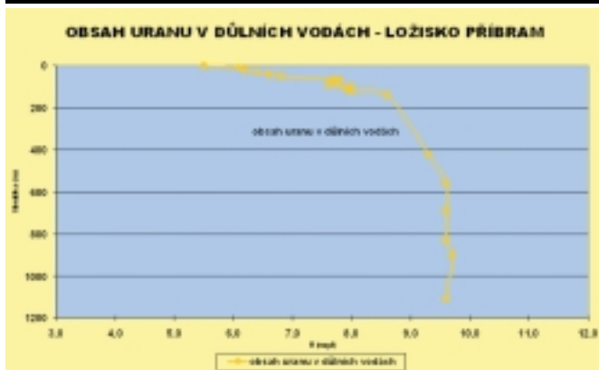
Obr. 3: Příklad změny obsahu uranu v důlních vodách v zatopeném dole v závislosti na hloubce (dle [2])
