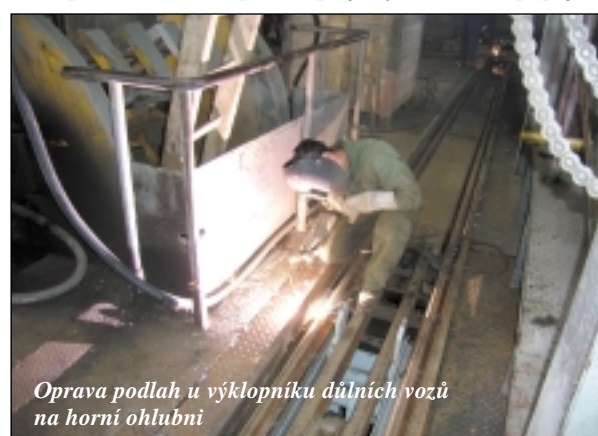
Oprava zarážky a pneumatického ovládání výklopníku na horní ohlubni jámy R1
