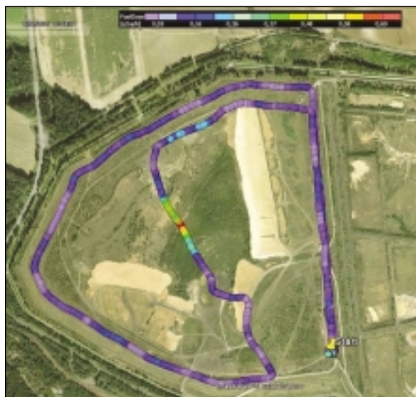
Výstup měření příkonu fotonového dávkového ekvivalentu H_x [ \mu\text{Sv/h} ] v prostoru I. etapy odkaliště Stráž pod Ralskem. Pozn.: Rozsah barevné škály 0,05 až 0,75 \mu\text{Sv/h} ; H_x přírodního pozadí 0,15 \mu\text{Sv/h} (modrá barva).
